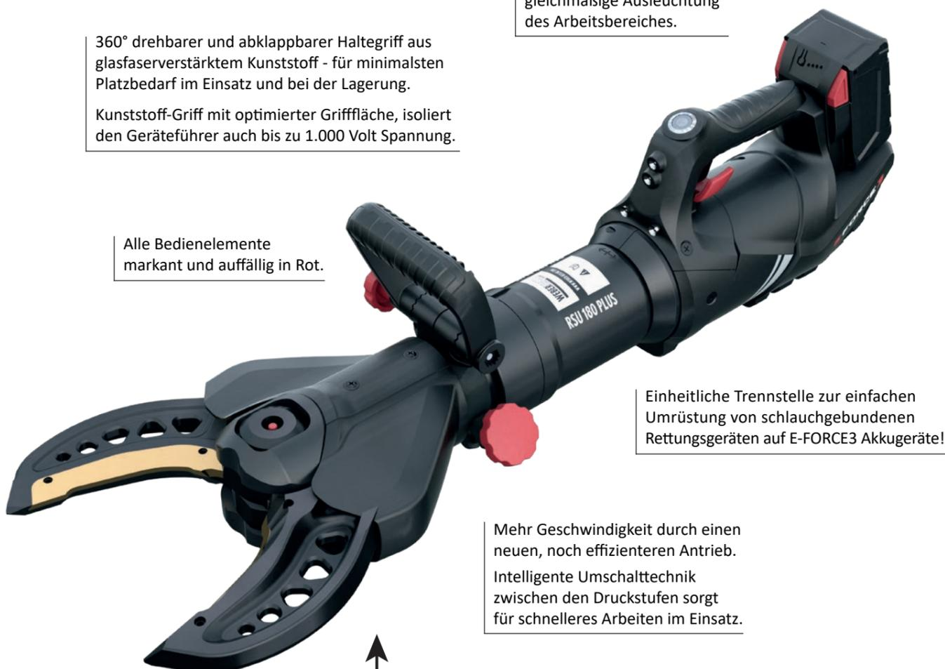
Einheitliche Trennstelle zur einfachen Umrüstung von schlauchgebundenen Rettungsgeräten auf E-FORCE3 Akkugeräte!
